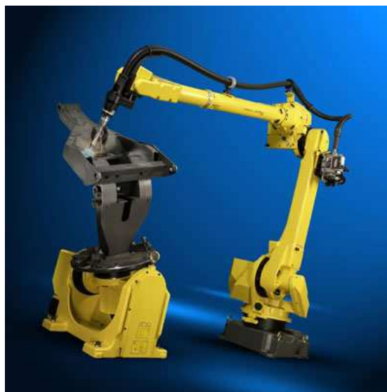
Rys. 12. Robot wyposażony w narzędzie do spawania łukowego
