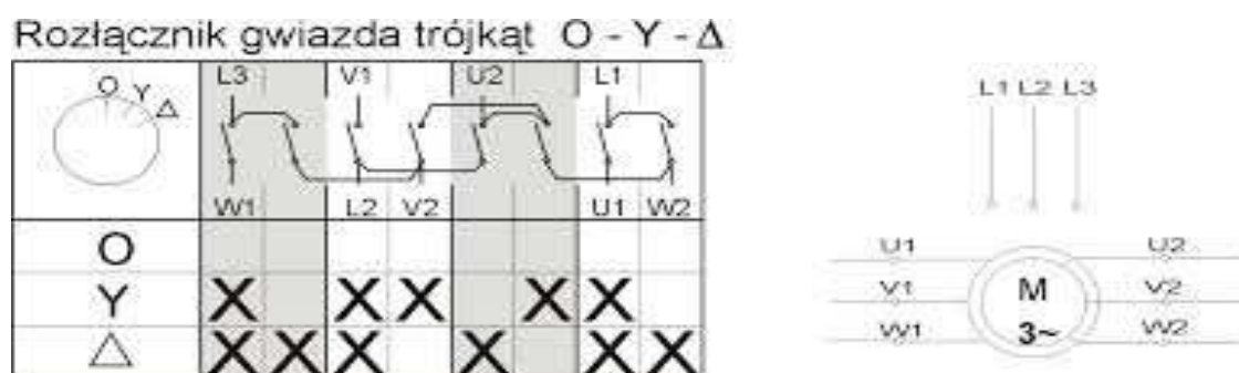
Rys. 10. Schemat połączenia łącznika Apator serii 4G10
