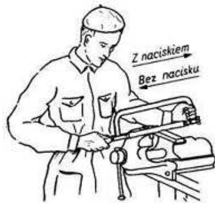
Rys. 12. Cięcie piłką ręczną - prawidłowa postawa przy przecinaniu.
